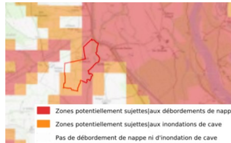
Figure 50 – Remontée de nappe au niveau de l'AEI (source : BRGM)
